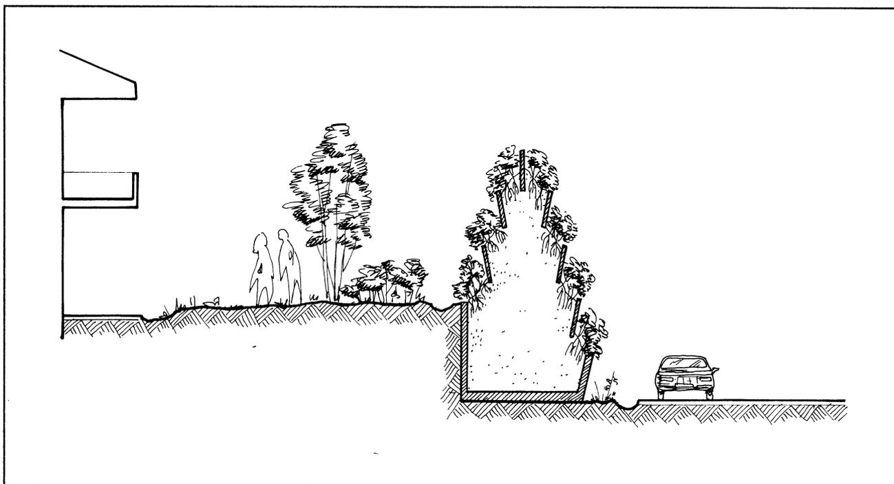
Fig. 24 - Barriere antirumore in elementi prefabbricati in calcestruzzo
