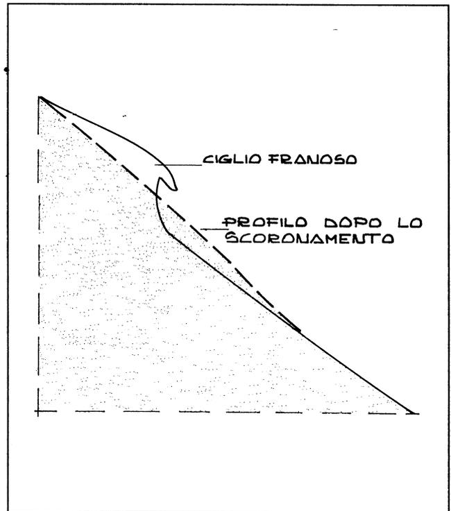
Fig. 18 - Lavori di modellamento del pendio franoso
