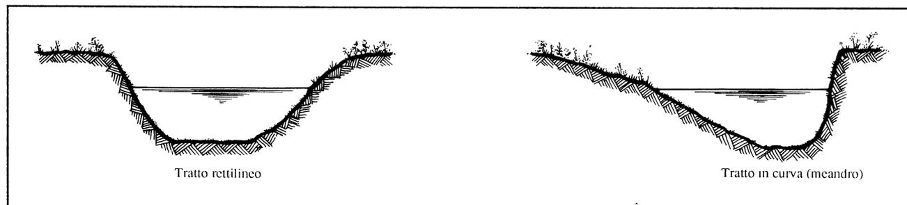
Fig. 3 - Variabilità morfologica di un alveo fluviale (Lachat, 1991 - modificata)
