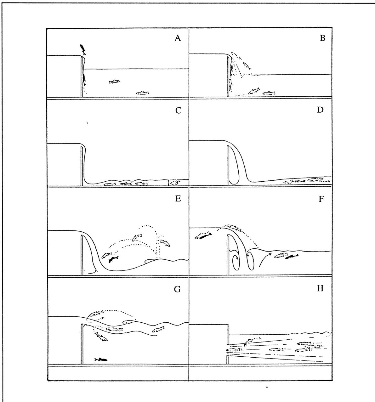
Fig. 48 - Comportamenti dell'ittiofauna in presenza di un ostacolo artificiale al variare del deflusso idrico (Stuart, 1962)
